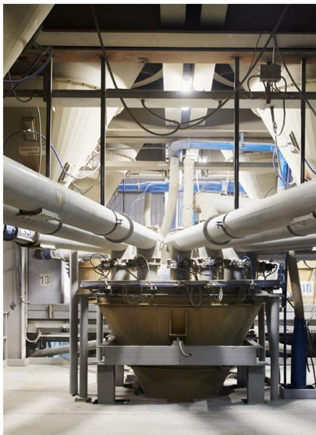
Автоматическое взвешивание и дозировка исходных сырьевых компонентов
